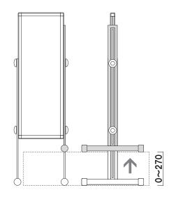
段差対応:0~270mm 傾斜対応:0~15度
