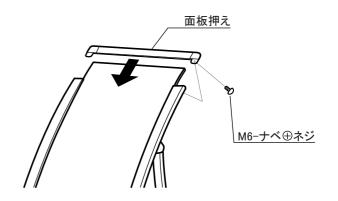
本体裏面のボルトをはずし、面板を交換してください。 ※**別途ドライバーが必要です。**
