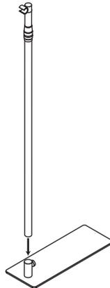
**3** 横棒を連結し、パイプ先端のジョイント部分にはめ込みます
