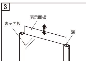
フレームとコーナーピースを外したら、フレームの溝にセットされている表示面板を引き抜きます。印刷等をされてから再度溝に差し込み、フレームとコーナーピースを戻してセット完了です。
