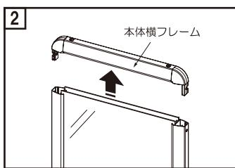
ビスを外したら、上部の本体横フレームとビスで固定されたコーナーピース2ヶのセットを引き抜いて外します。
