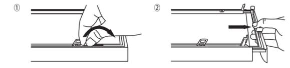
裏面(新システム) 価格表の で塗られているサイズに新システム「強化プラスチック製ロックコーナー」が使用されます。
