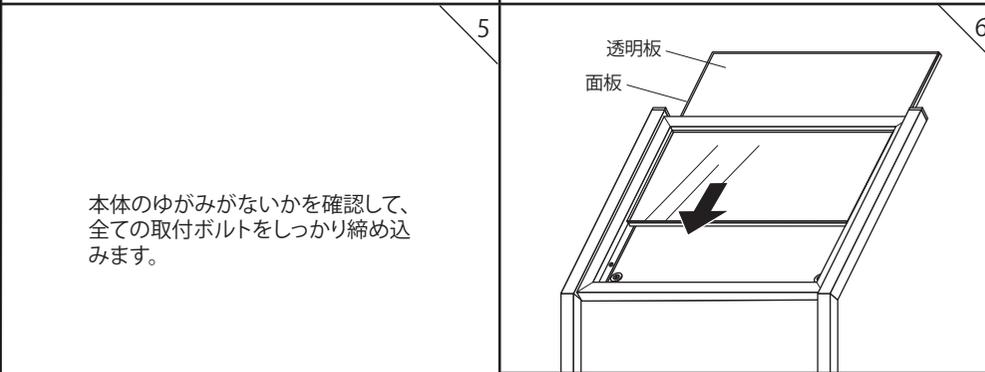
本体のゆがみがないかを確認して、全ての取付ボルトをしっかり締め込みます。
