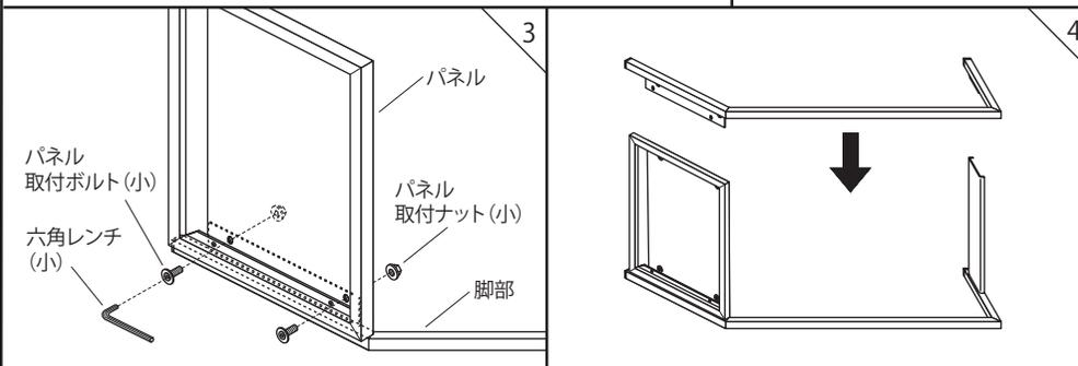
脚部とパネルを六角レンチ(小)を使ってパネル取付ボルト(小)で固定します。
