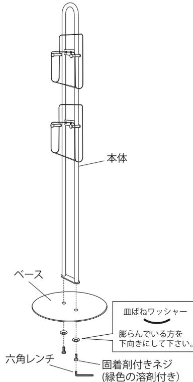
図のように、本体とベースを組み立てます。(ゆらみ防止のため、本体とベースの固定に固着剤付きネジを使用していますので、いったんネジを締めるとはずしにくくなります。)
