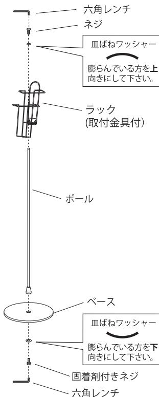
図のように、ポールとベースを組み立てます。（ゆるみ防止のため、ポールとベースの固定に固着剤付きネジを使用していますので、いったんネジを締めるとはずしにくくなります。）次にポールにラックを固定して完成です。
