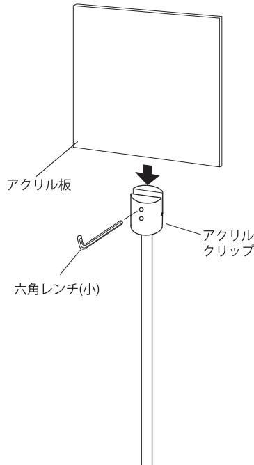
アクリル板をアクリルクリップの溝に挟みこみ、六角レンチ(小)で締めるとアクリル板が固定します。
