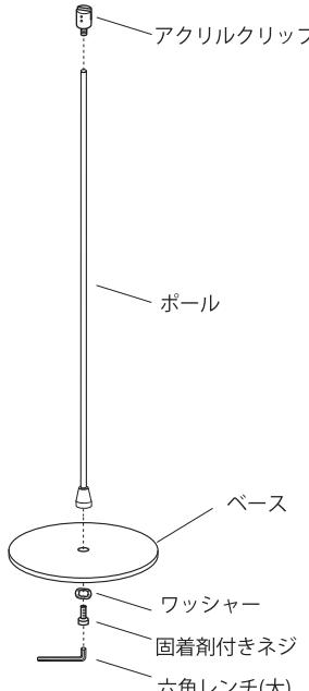
図のように、ポールとベースを組み立てます。（ゆるみ防止のため、ポールとベースの固定に固定剤付きネジを使用していますので、いったんネジを締めるとはずしにくくなります。）
