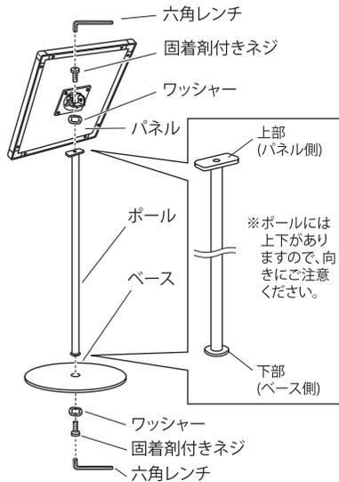
ポールにパネルとベースをワッシャー・ネジでしっかりと締めて固定します。(ゆるみ防止のため、固着削付きネジを使用していますので、いったんネジを締めるとはずしくなくなります。)
