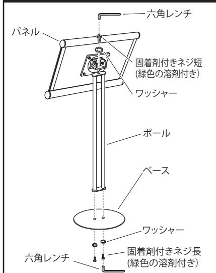
パネルとベースをそれぞれポールにワッシャー・ネジでしっかりと締めて固定します。(ゆるみ防止のため、ポールとベースの固定に固着剤付きネジを使用していますので、いったんネジを締めるとははずにくくなります。)
