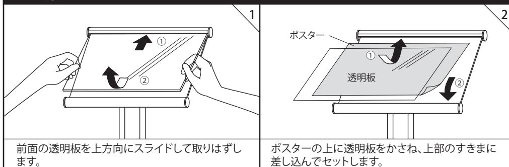
前面の透明板を上方向にスライドして取りはずします。
