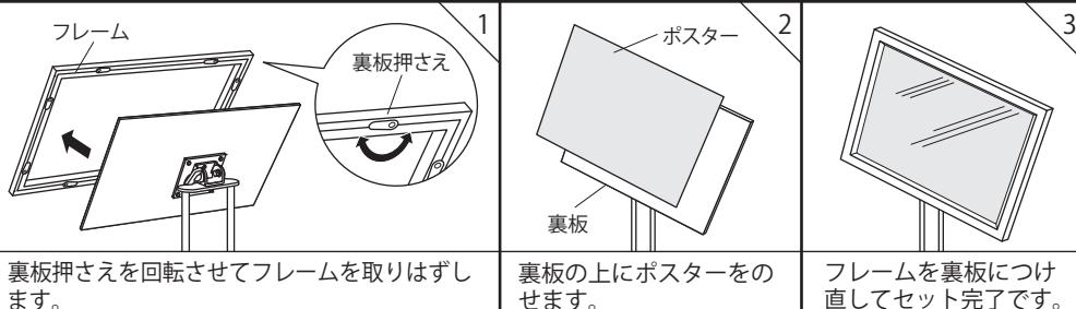
裏板押さえを回転させてフレームを取りはずします。
