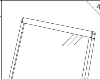
上辺フレームを元に戻し、上辺フレーム両端の金具でロックします。
