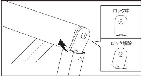
上辺フレーム両端の金具を手前に少し回し、ロックを解除します。
