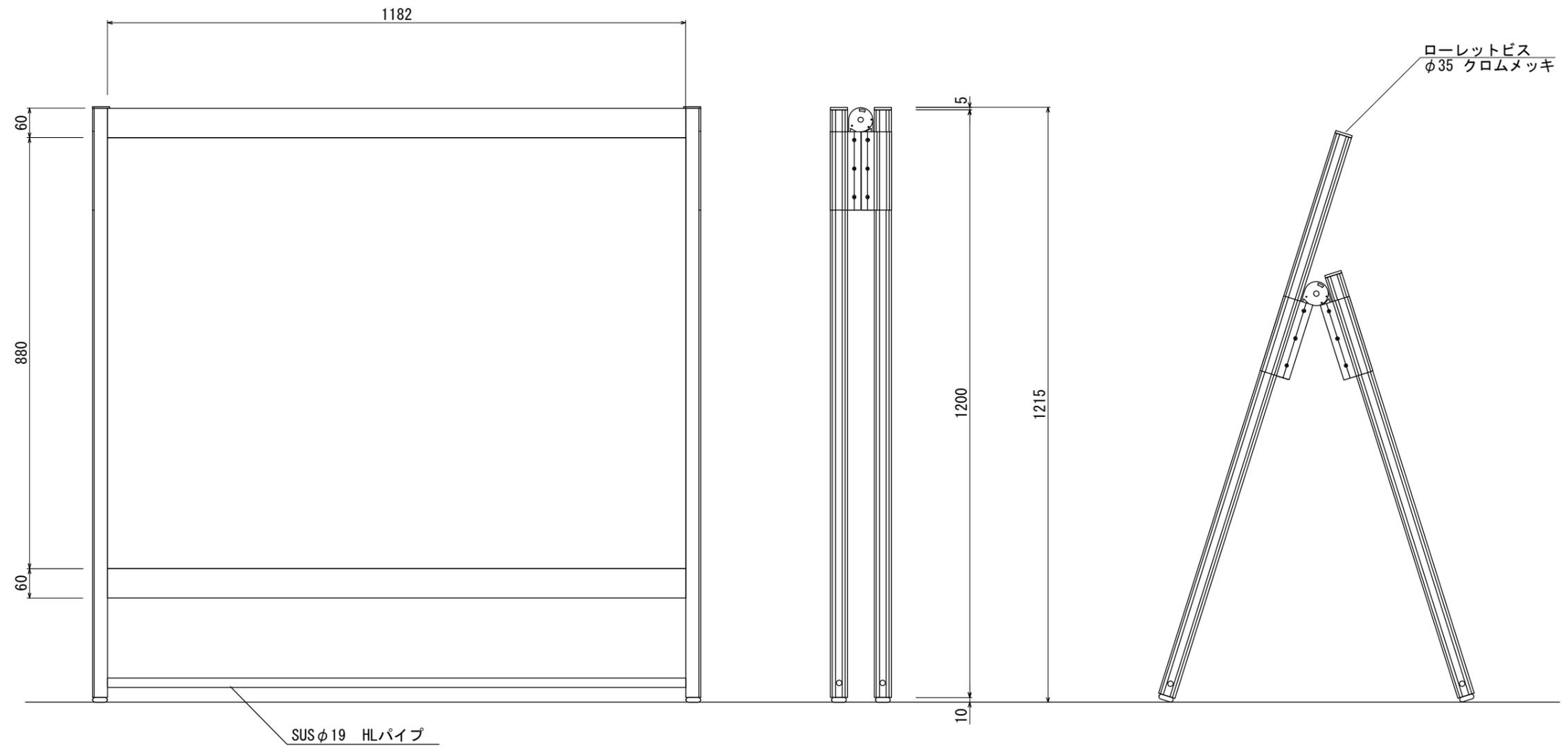
フレーム: アルミ押出型材、アルマイトシルバー仕上
