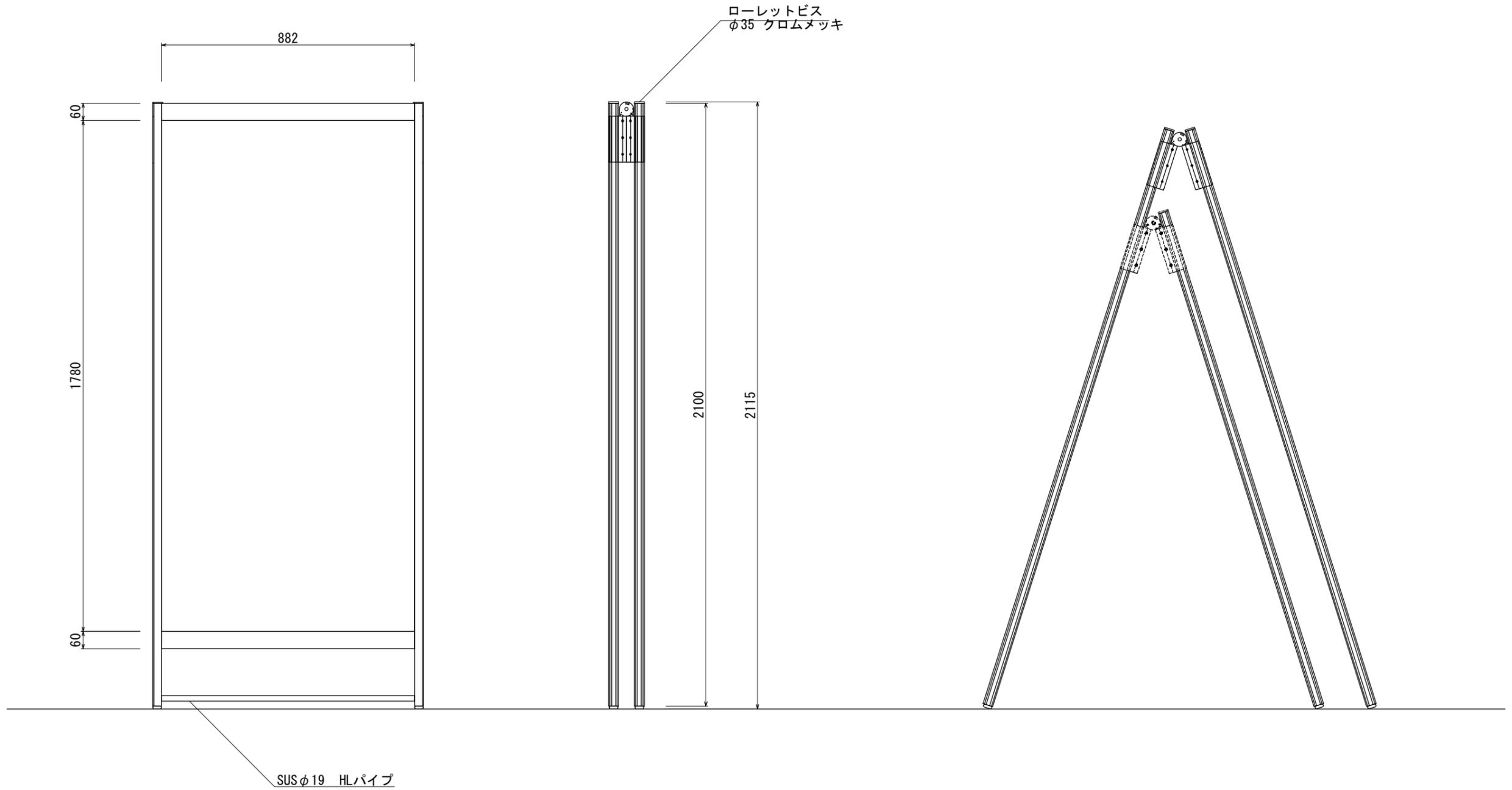
フレーム: アルミ押出型材、アルマイトシルバー仕上
