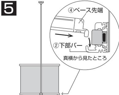
図のように④ベース先端を下部バーにはめ込みます。下部バーの横幅にたいして中心になるようにしてください。
