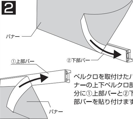
ベルクロを取付けたバナーの上下ベルクロ部分に①上部バーと②下部バーを貼り付けます。
