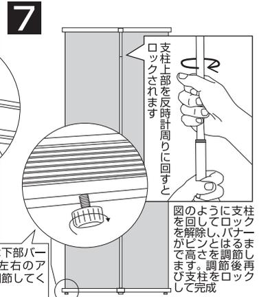
支柱上部を反時計回りに回してロックされます
