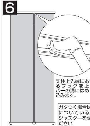
支柱先端にあるフックを上バーの溝にはめ込みます。
