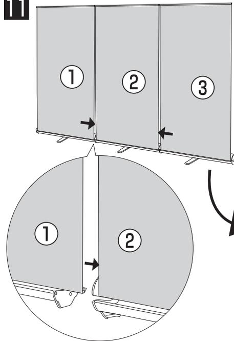
本製品は連結させての使用ができます。連結するときは、①と③のバナーを②がある側にスライドさせることによってバナー間の隙間をめたなくすることができます。
