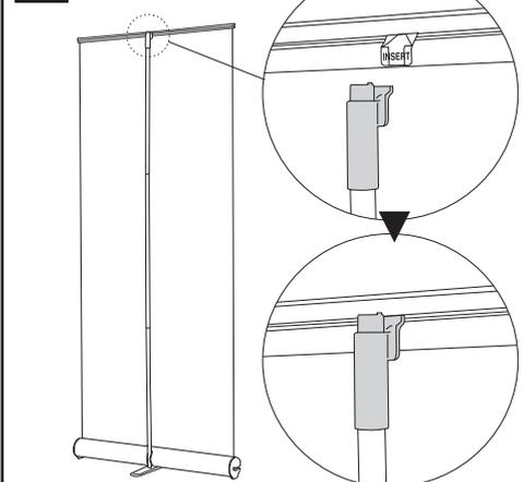
**8** ポールの先端部分が上部バーにしっかりと差し込まれているのを確認の上、本体側面についているピンを引き抜いて下さい。
