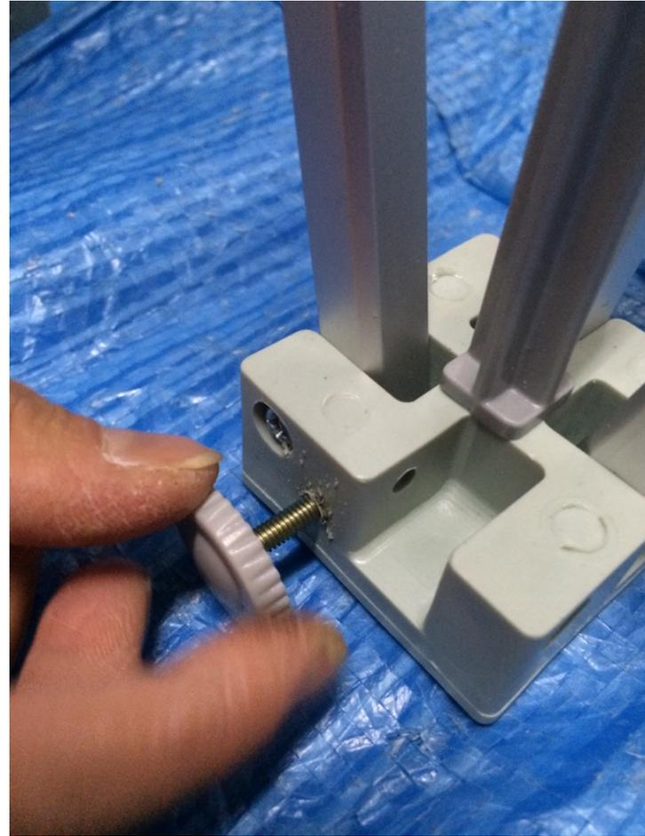
このように手前のネジが邪魔をしてドライバーが入りにくく、外しにくい場合はネジを外してください
